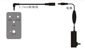
4、可以使用反极性转接头给效果器供电或者其他参数符合的设备供电。
