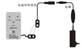
3、可以使用3.5mm转接头给效果器供电或者其他参数符合的设备供电。
